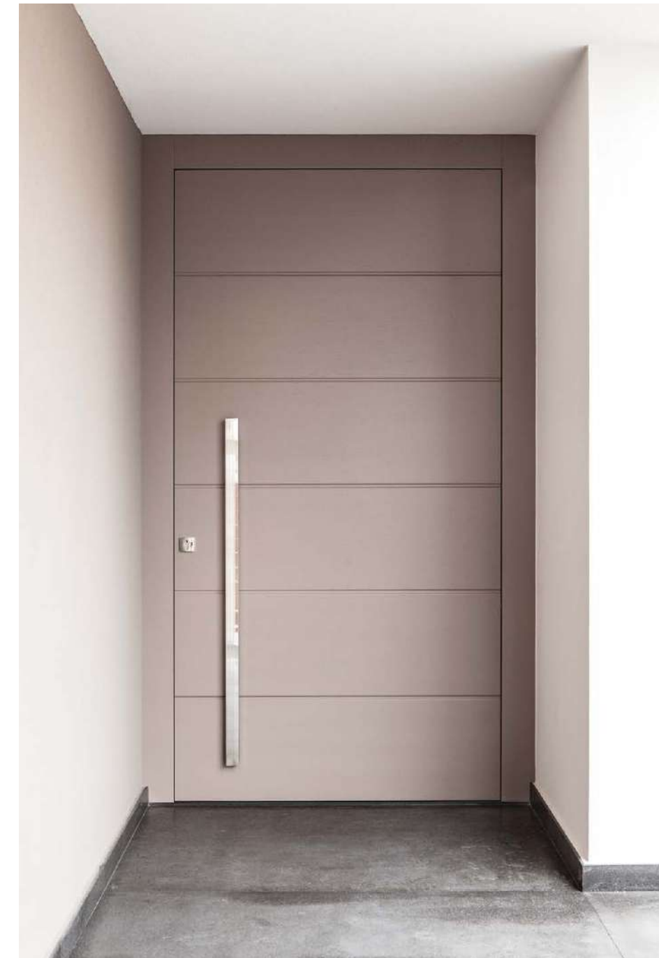
Portone in rovere laccato a vena aperta pantografato con anta di sezione 92 mm. L'apertura è a bilico verticale con paraspifferi magnetico. Il maniglione è stato realizzato su misura in acciaio inox a specchio. Lacquered Pantographed Oak Entry Door, width 92 mm. Vertical pivot with magnetic weather-stripping. Custom-made door handle in polished stainless steel.
