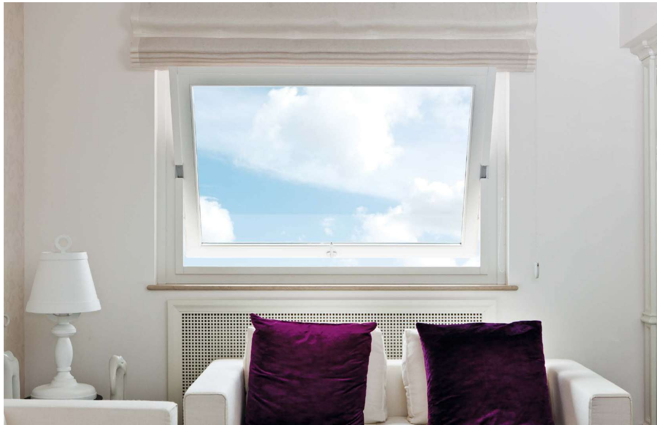
Finestra ad un'anta con apertura a bilico orizzontale con cerniera in metallo satinato (portata 300 kg). Single horizontal pivot window with satin aluminium hinge (capacity 300 kg).
